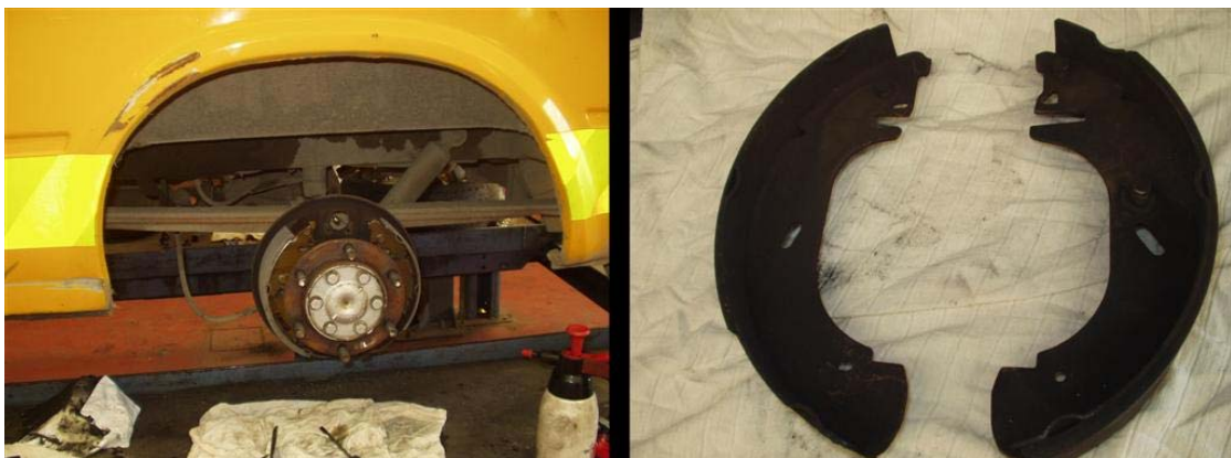
Σχήμα 18.1 Αμίαντος σε τακάκια φρένων φορτηγού
