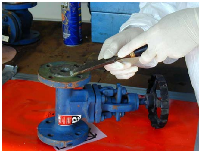
Σχήμα 11.5 Χρήση αποκλειστικά εργαλείων χειρός για τον καθαρισμό της τσιμούχας αμιάντου και των υπολειμμάτων από τη βαλβίδα.
