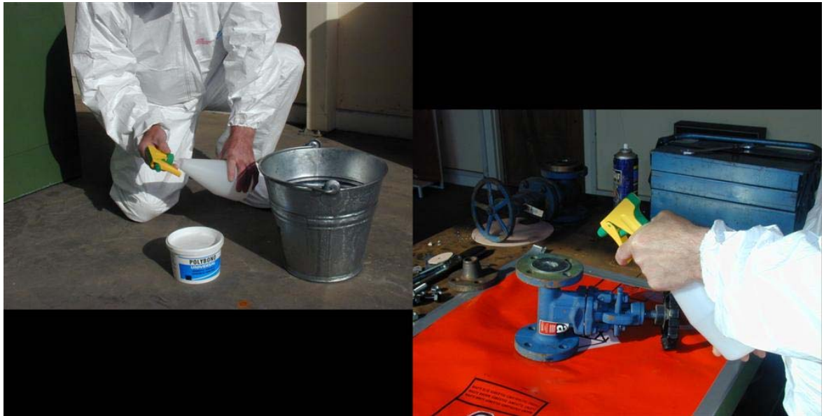
Σχήμα 11.4 Ύγρανση της τσιμούχας αμιάντου στη βαλβίδα
