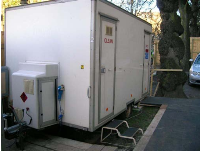
Σχήμα 12.6 Κινητή μονάδα απορρύπανσης
