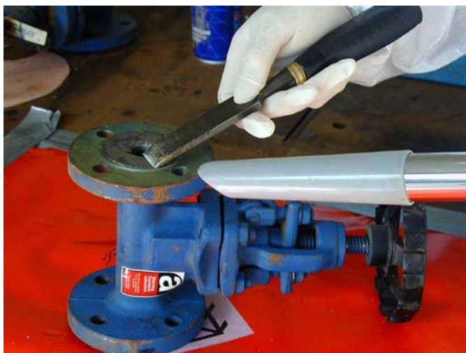
Σχήμα 11.5 Χρήση αποκλειστικά εργαλείων χειρός για τον καθαρισμό της τσιμούχας αμιάντου και των υπολειμμάτων από τη βαλβίδα.
