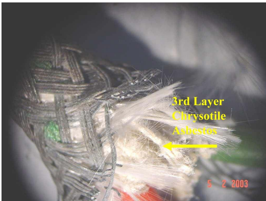
Σχήμα 4.9 Μονωμένα καλώδια με ένα στρώμα αμιάντου στη μόνωση.
