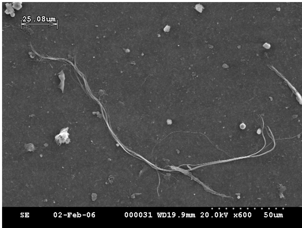
Σχήμα 2.2 Εικόνα από σαρωτικό ηλεκτρονικό μικροσκόπιο που δείχνει ίνες χρυσοσιλικού αμιάντου
